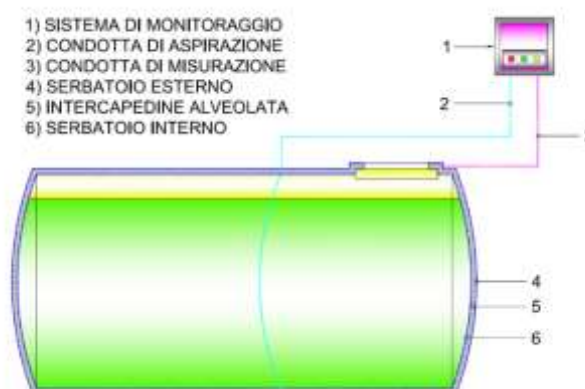
Figura 5-2 SCHEMA FUNZIONALE DI MONITORAGGIO
