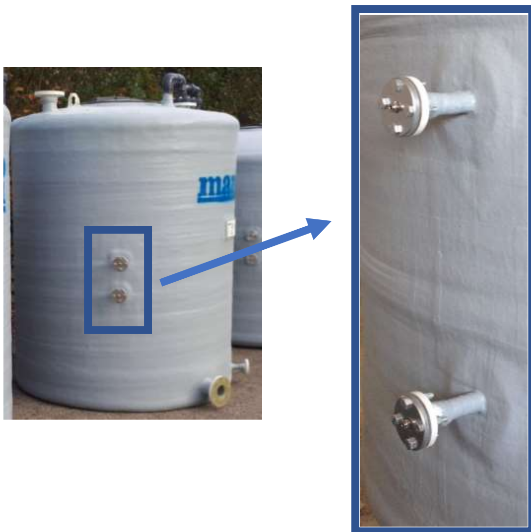
Figura 5-3 Attacco ad innesto rapido per tubo Rilsan da \Phi 8 mm
