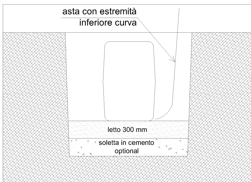
Figura 8 Eliminazione vuoti con asta curva
